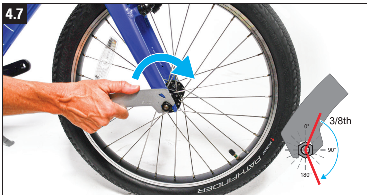
Fig. 4.7 ■ Spænd hjulets akselmøtrikker til 186 in-lbf/21 Nm, hvilket svarer til ca. 3/8 omdrejning (fig. 4.2 B).
