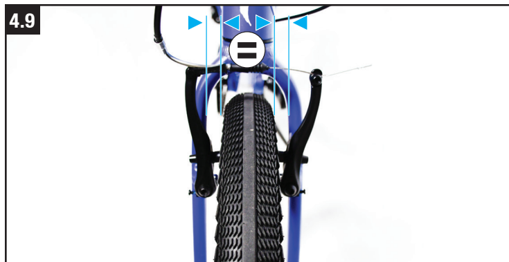
Fig. 4.9 Løft cyklens forende op og drej forhjulet hurtigt rundt. Hjulet skal sidde midt i gaffelkronen, dreje frit og hverken "hoppe" eller "bølge".
